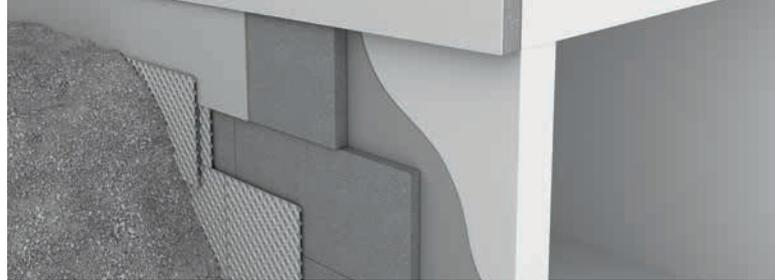
Perimeter- und Sockeldämmung
